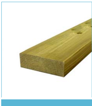
Magatello in larice impregnato dimensioni 30x75x2000 mm (raccomandato 4ml al mq)
